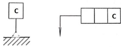
Referentna površina je površina A i upisuje se u treće polje, dok je simbol za paralelnost  $\text{//}$  koje se unosi u prvo polje, dok se u drugo unosi vrednost tolerancije  $\pm 0.3\text{mm}$ , na slici je dat prikaz tolerancije oblika i položaja.
