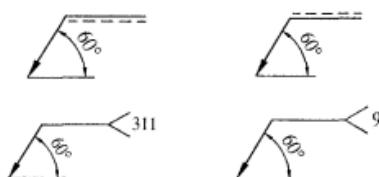
Spoj mašinskih delova ostvaren lemljenjem označava se na isti način kao i zavareni spoj. U pravcu račve upisuje se broj 9. Iznad referentne linije upisuje se oznaka vrste šava.
